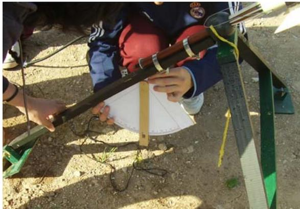
Velocidad de salida: Fue muy difícil medir la velocidad de salida de la rampa, pero pudimos medir con un sensor digital construido en Escuelas ORT una velocidad de  $41 \text{ m/s}$  en un tiro con una presión de  $40 \text{ psi}$ .
