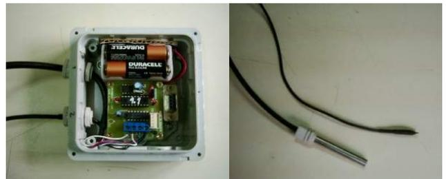
**Fig 2: Logger y sensores de temperatura**
